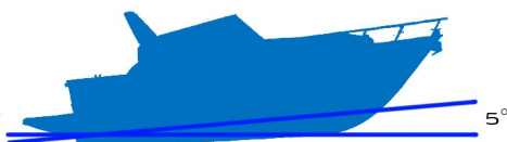
ASSETTO DI UN'IMBARCAZIONE PLANANTE ALLA VELOCITÀ DI CROCIERA DI 22 KNS
