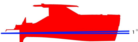
ASSETTO DELL'IMBARCAZIONE MYTIC ALLA VELOCITÀ DI CROCIERA DI 16 KNS
